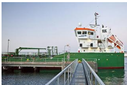
MS Eken, en av Thunbolagens torrlastare i Vänermax-storlek (max 89 m långa och 13,4 m breda), är ett exempel på den småskaliga IMO-sjöfarten. Fartyget med 4 800 dwt är anpassat för slussarna i Trollhättan. Foto: Erik Thun AB
