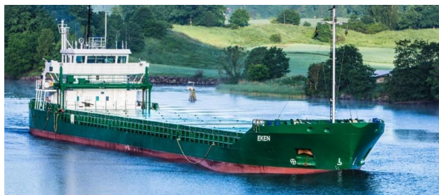
MS Eken, en av Thunbolagens torrlastare i Vänermax-storlek (max 89 m långa och 13,4 m breda), är ett exempel på den småskaliga IMO-sjöfarten. Fartyget med 4 800 dwt är anpassat för slussarna i Trollhättan. Foto: Erik Thun AB
